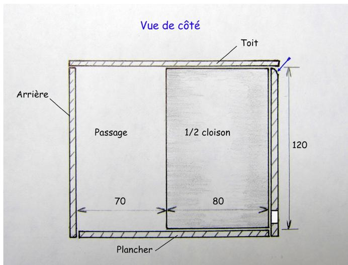
Les côtes, en mm, sont les côtes intérieures à respecter à + ou - 10mm ! Les dimensions de découpe du bois sont donc à calculer suivant l'épaisseur du bois utilisé.
